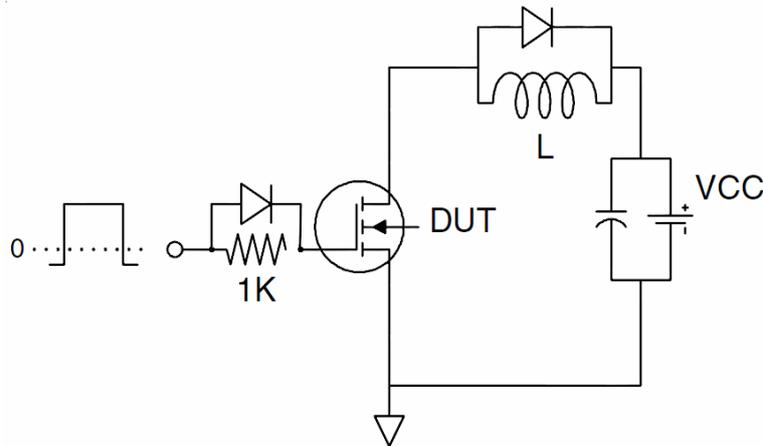
**3) Switch Time Test Circuit**
